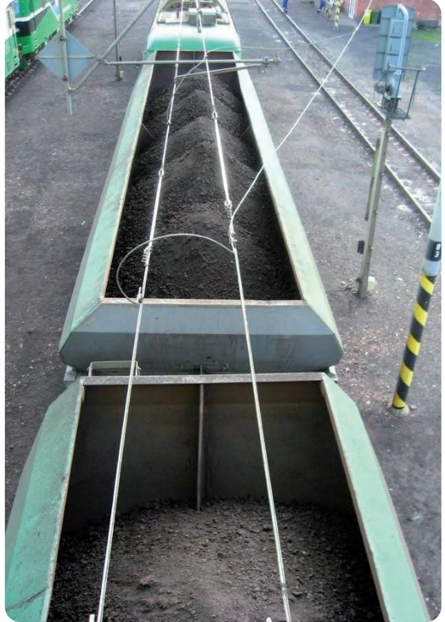
Waggonauskleidung mit Matrox SI 12: Das problemlose und saubere Entleeren jedes einzelnen Waggonen sorgt für eine schnelle Entladung ganzer Güterzüge.
