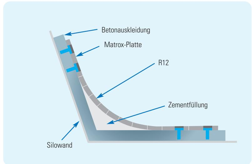
Befestigung einer Bunkerauskleidung.
