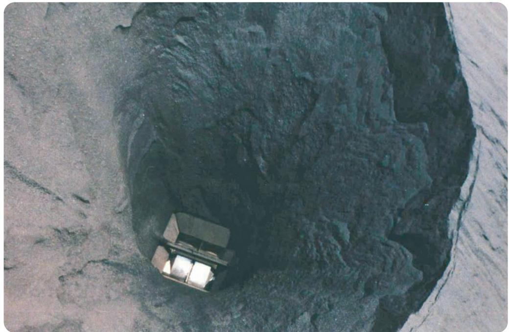
Kernfluss, sog. „Rattenloch“: Der mittlere Teil des Bunkers wird zuerst in Form eines Trichters entleert. (Foto mit freundlicher Genehmigung der Solids Handling Technologies, Inc.)
